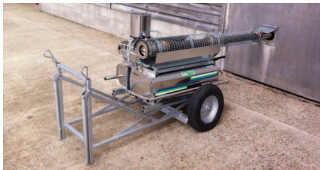
Illustration 4. Brumisateur thermique (photo de Agrex Limited)
